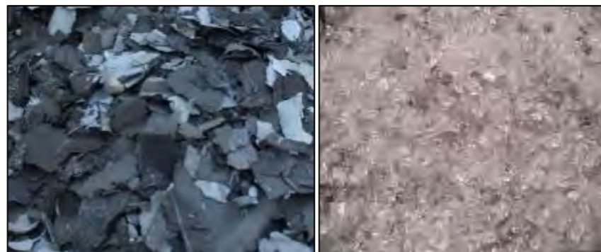
Figure 37 : Fragments de silicium et granules de verre (Source : Soren, photovoltaïque.info)
